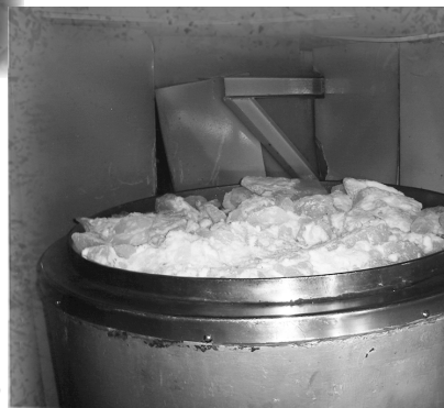
Derretidor de Acero Inoxidable cargado con hielo
